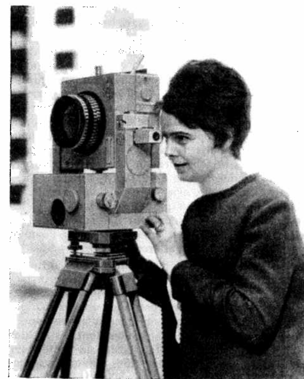
Fig. 3. La nouvelle chambre métrique UMK-10/1318 de Jena (Photo VEB Carl Zeiss Jena)
