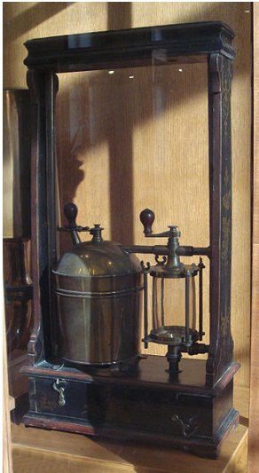
Bomba de incendio, máquina de Savery (1698), construcción del siglo XVIII (Fotografía: Wikimedia Commons)
